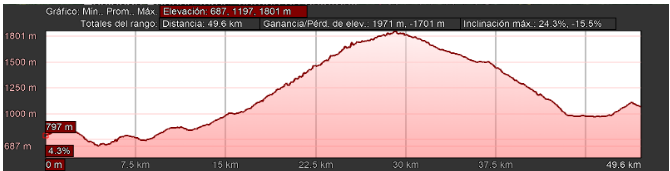
Ilustración 5. Altimetría Peaje Caiquero a Guaduas
